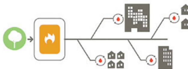
Chaufferie raccordée à plusieurs bâtiments
