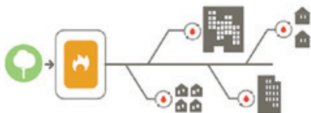
Chaufferie raccordée à plusieurs bâtiments
