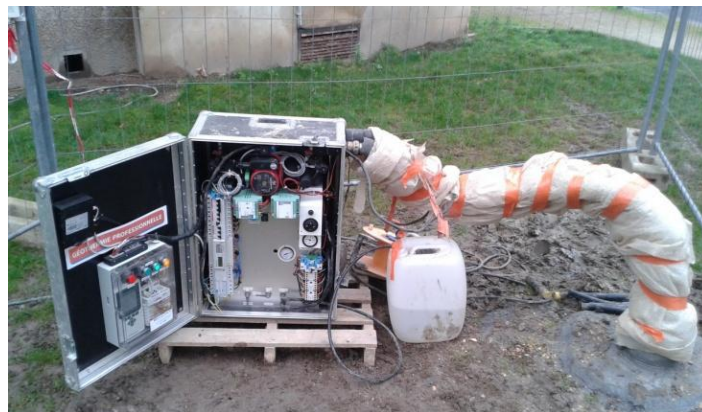
Figure 9 : Dispositif de test de réponse thermique (Ecome, 2015)
