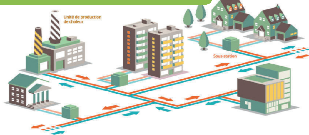
FIG 24 | Schéma de principe d'un réseau de chaleur (ADEME Île-de-France)
