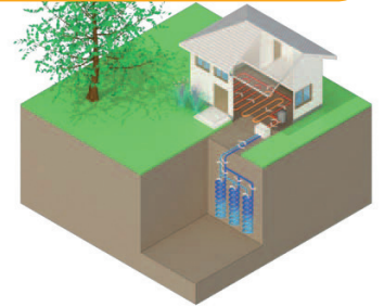
FIG 3 | Principe des fondations thermoactives
